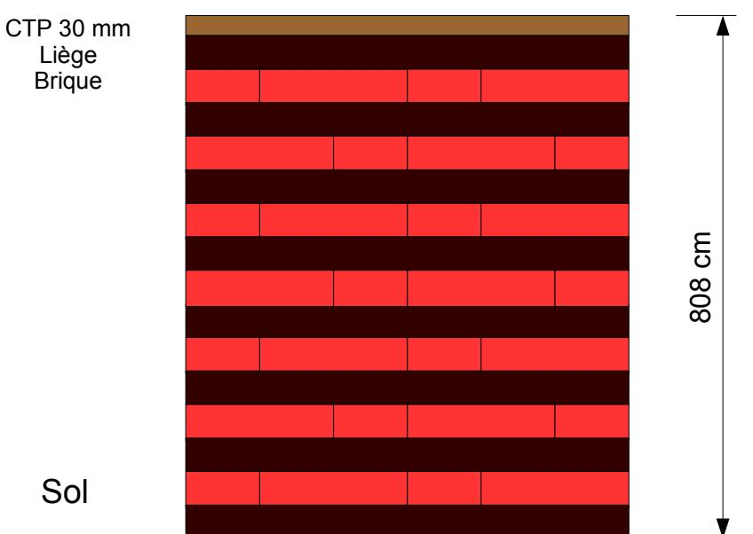
Brique : 7 rangées de 12 briques. Total 84 briques, poids 211 kg
