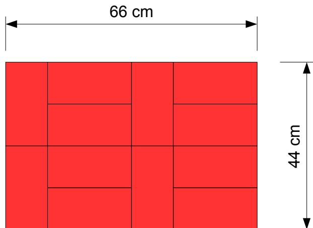
Coupe : Alternance liège+brique avec un socle en CTP de 30 mm sous la platine.
